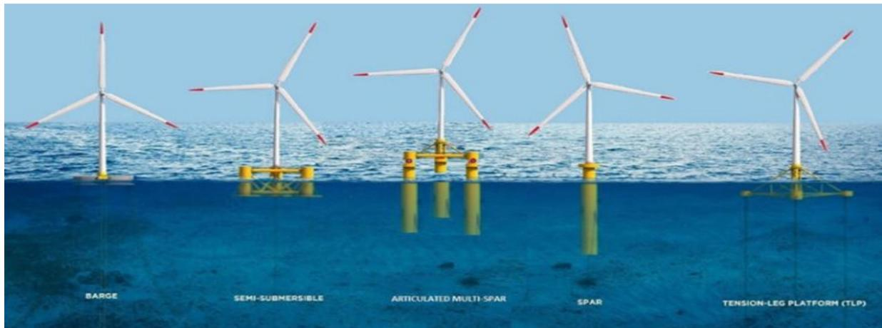
**Figure 2** : Les différents prototypes d'éoliennes flottantes (source : windpowerengineering.com)
